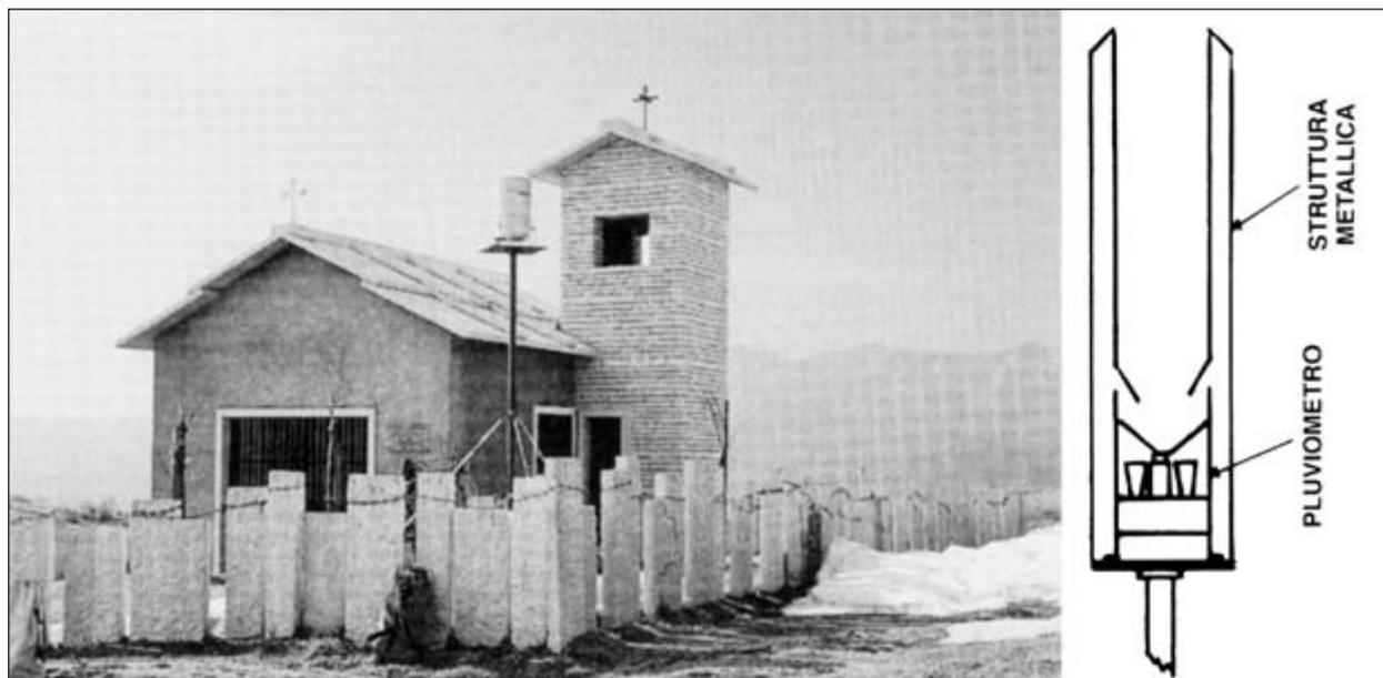
Fig. 17. La stazione pluviometrica della Spluga della Preta nell'aprile 1993. A lato è riportata in sezione la struttura metallica montata sul pluviometro nel periodo invernale per aumentare la capacità di raccolta delle precipitazioni nevose.
