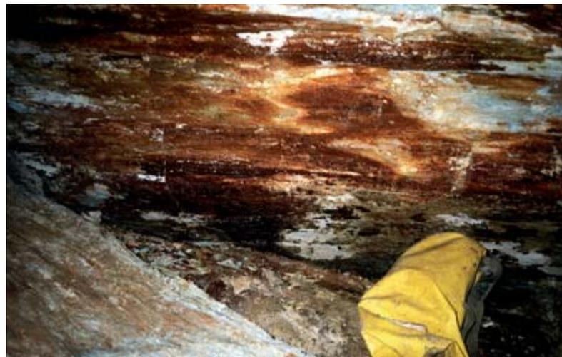
Fig. 6. Superficie di faglia trascorrente ad alto angolo nelle gallerie del Vecchio Trippa. Le argille rosse e verdi che caratterizzano gli interstrati in questo settore sono state spremute all'interno delle superfici tettoniche, svolgendo azione lubrificante. È per questo motivo che la maggior parte delle strutture tettoniche osservabili si concentra in questo livello stratigrafico (foto E. Anzanello).
